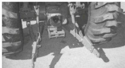
Рис. 16. Нижние рычаги трактора
